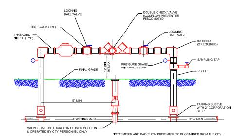
TEMPORARY JUMPER CONNECTION DETAIL
